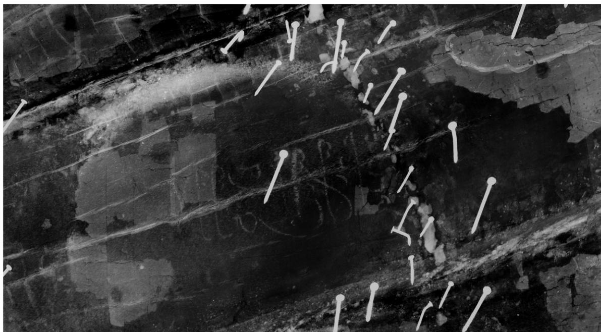
Il.16. Letras árabes aparecidas en la bóveda central en el reverso de la piel. El estado de conservación de la madera de chopo que aparece atacada por pudrición cúbica, la superposición de la piel deteriorada, los restos de pintura original y los estucos de cera proporcionan una imagen confusa que dificulta su lectura. Applus, Radiografía B2CE2-4, 2010, placa radiográfica, Patronato de la Alhambra y Generalife, Archivo.
