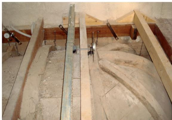
Il. 28. Pedro Salmerón Escobar, 2008, fotografía. Vista del sistema de suspensión empleado en la bóveda B1 reutilizando las vigas de madera colocadas en la intervención de 1976-1983. Se puede observar la presencia de los extensómetros para la prueba de carga.
