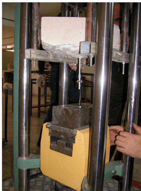
Il. 15. Pedro Salmerón Escobar, 2007, fotografía. Ensayo del tensor y anclaje del sistema de suspensión empleado en las cúpulas de mocárabes M2, M4 y M6. Prueba realizada a cargo de Juan de Mata Vico Rodríguez en los laboratorios de la Escuela de Arquitectura Técnica de Granada (en la actualidad ETS Ingeniería de la Edificación).
